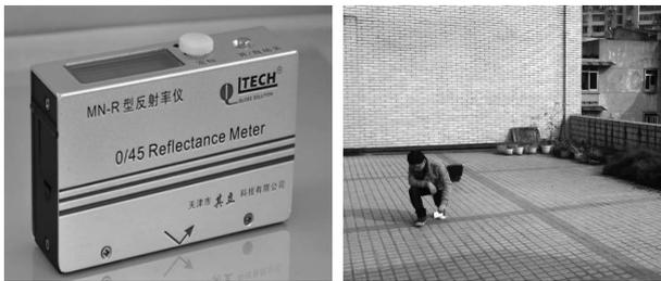
图 5 反射率测试仪器及测试过程
