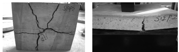
图8 S12P2底面及侧面裂缝图
