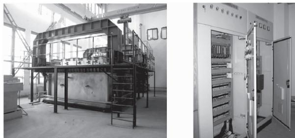
(a) 水平试验炉 (b) 控制系统
