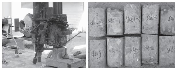
(a) 混凝土取芯 (b) 取芯后混凝土试样
