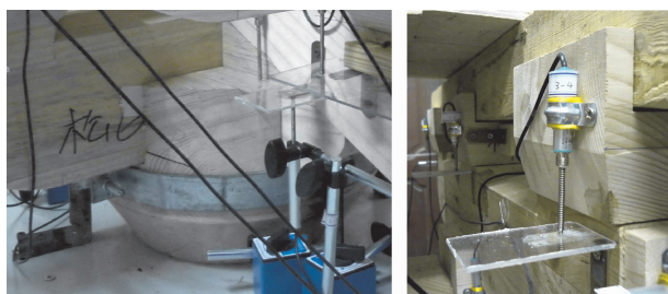
图 1 卢斗及位移传感器固定细部
