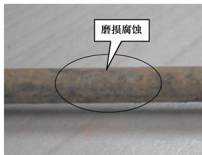
图2 钢丝磨损腐蚀
