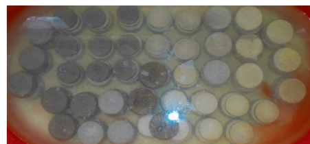
(a) 抗剪强度试件的养护
