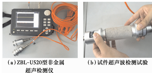
图 5 超声波损伤检测试验
