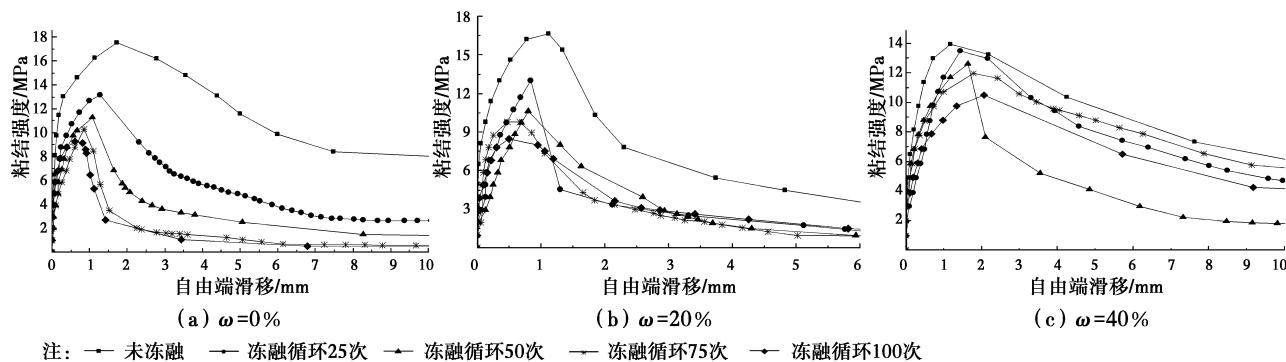
图 6 冻融环境下试件的粘结强度-滑移曲线
