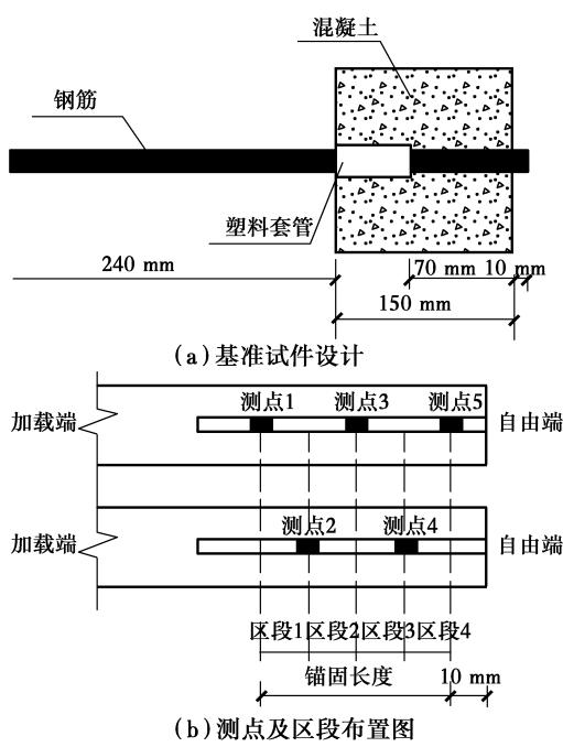
图 1 试件设计简图
