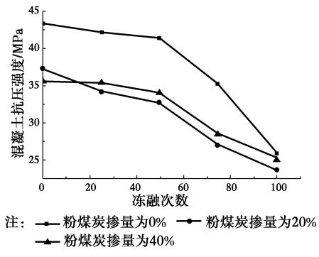
图7 冻融环境下粉煤灰混凝土抗压强度
