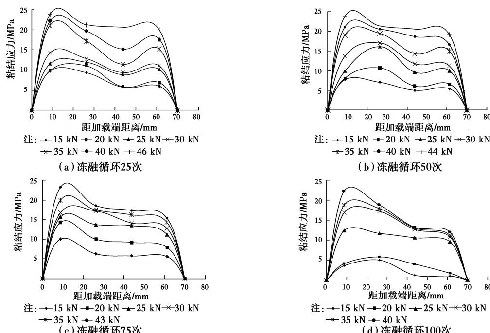
图 9 冻融环境下粉煤灰混凝土试件钢筋应变-锚固关系
