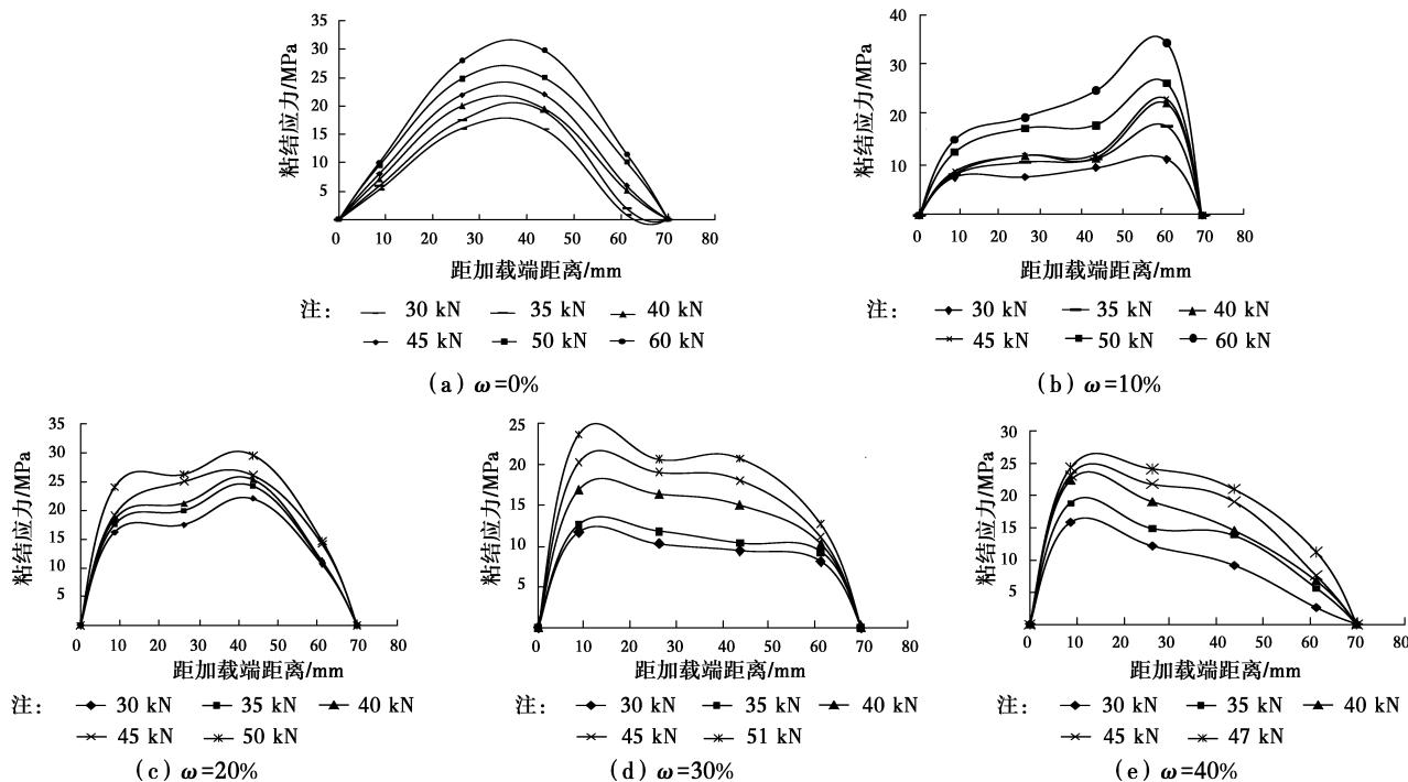
图 5 不同粉煤灰掺量下试件的粘结-锚固关系曲线
