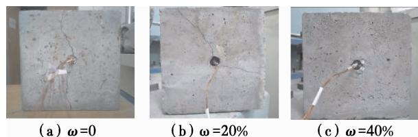
图 3 不同粉煤灰掺量试件直接拔出试验破坏现象
