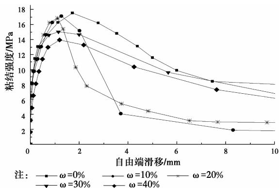
图4 不同粉煤灰掺量试件粘结强度-滑移曲线
