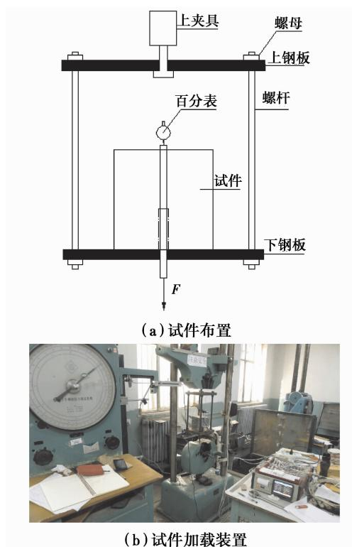
图 2 直接拔出试验加载装置
