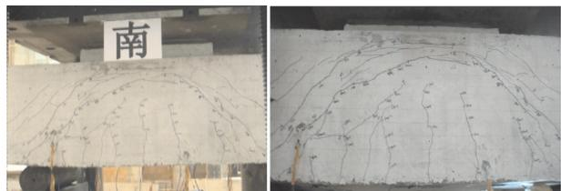
图 8 J1-3 南、北侧裂缝情况
