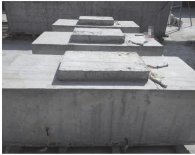
图 3 二次浇筑连接后试验模型
