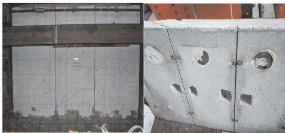
图 8 1号试件破坏状况图
