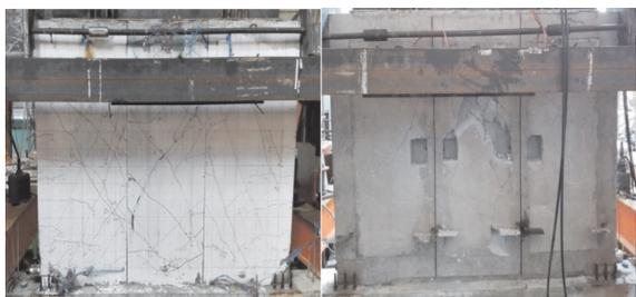
图 9 2号试件破坏状况图
