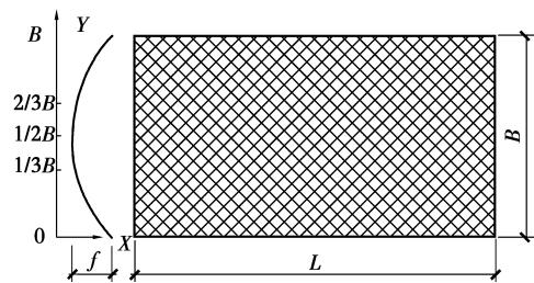
图 1 联方型单层柱面网壳结构模型图
