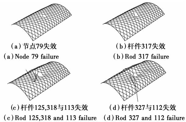
图6 节点失效后的倒塌过程
