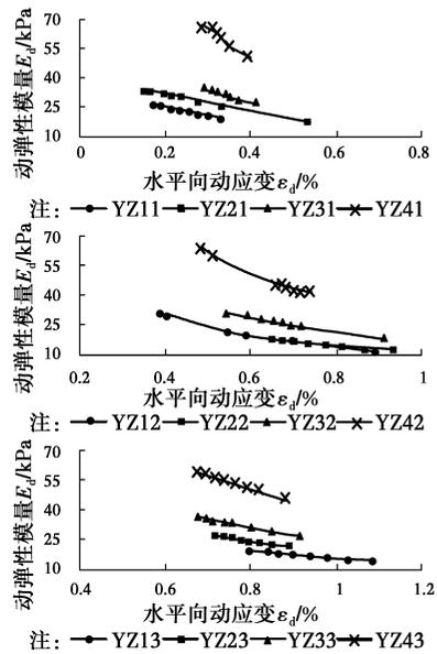
图 5 波浪荷载大小对动弹性模量影响
