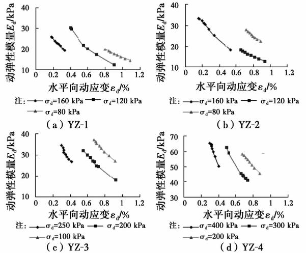
图 3 动弹性模量-水平向动应变曲线
