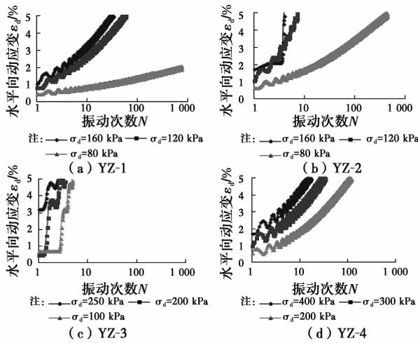
图 2 水平向动应变与振动次数关系曲线
