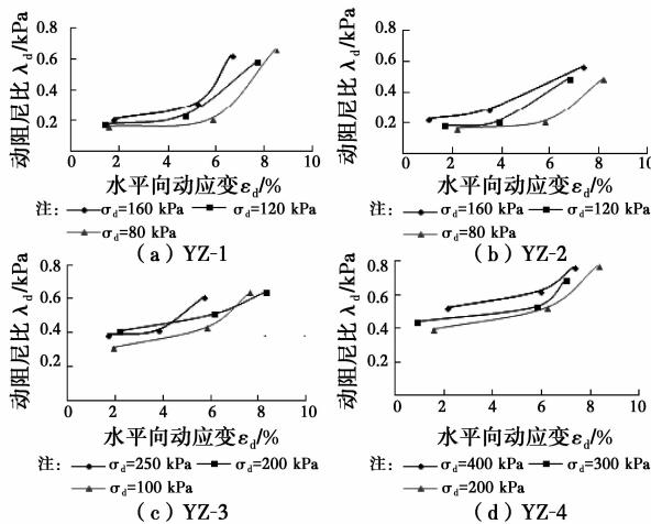
图 4 动阻尼比-动应变曲线
