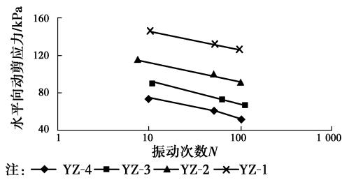
图 1 水平向动剪应力-振动次数曲线
