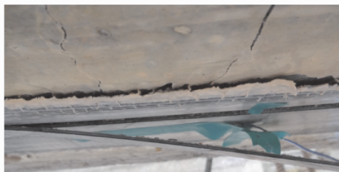
(b) CFRP 局部断裂
