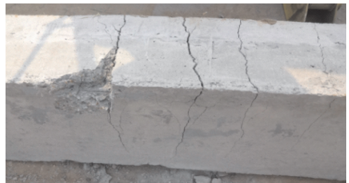
图 9 参照梁 BM1 的破坏形式
