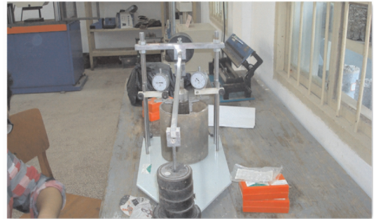
图 2 承载板法测回弹模量
