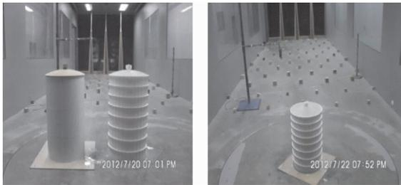
图2 风洞试验模型图
