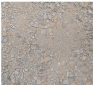
图 1 砖混结构生产的建筑垃圾细料
