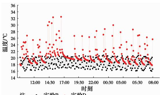
图 6 实验 B 和实验 D 条件下空调回风口温度逐时变化规律
