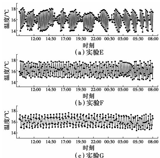
图9 实验E、F和G条件下室内空气温度逐时变化规律
