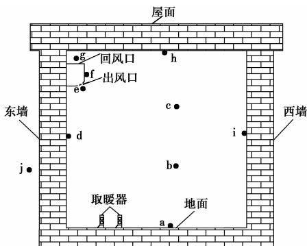
图 2 温度测点的布置
