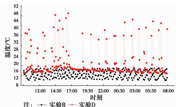
图 7 实验 B 和实验 D 条件下空调出风口温度逐时变化规律
