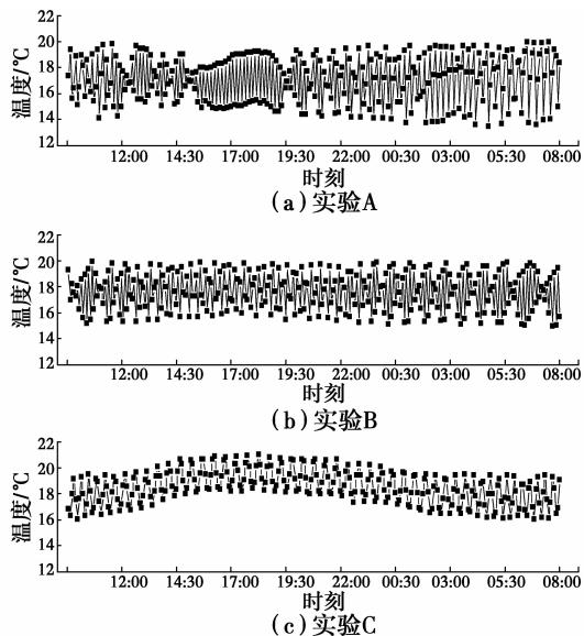
图8 实验A、B和C条件下室内空气温度逐时变化规律
