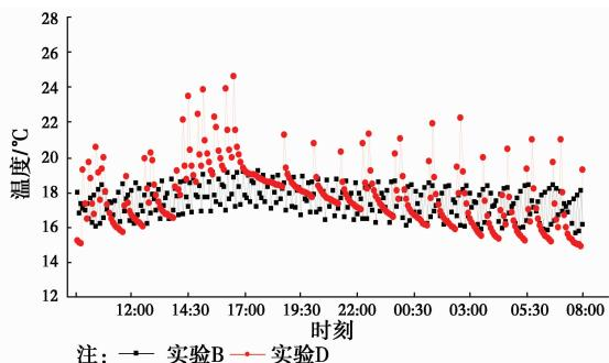
图 4 实验 B 和实验 D 条件下屋面温度逐时变化规律
