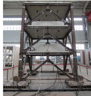
图 1 耗能梁段替换后的模型试件
