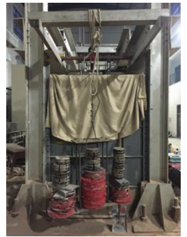
图 2 水平载荷试验 Fig. 2 The horizontal loading test
