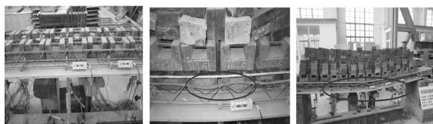
图 5 试件 B-4 各阶段破坏形态
