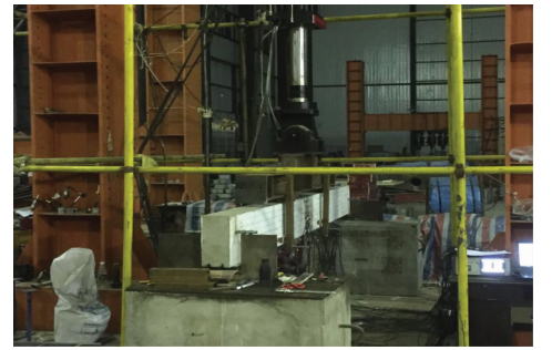
图 13 加固构件静力试验
