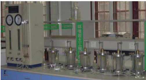
图 1 弥散实验装置 [22]
