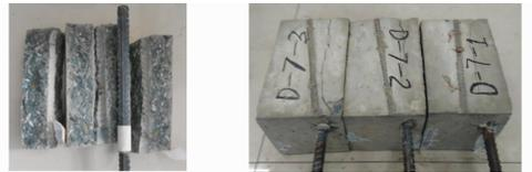
(a) 混凝土劈裂破坏(B-I-1) (b) 拉裂后钢筋拔出(D-VII组)
