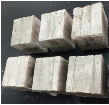
图2 制备完成的双缝砂浆试件
