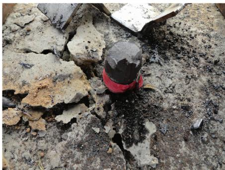
图 8 钢筋抗浮锚杆拔断破坏
