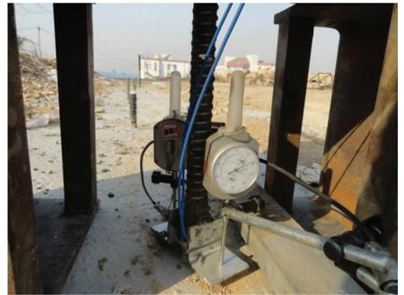
图 4 GFRP 抗浮锚杆测试装置图
