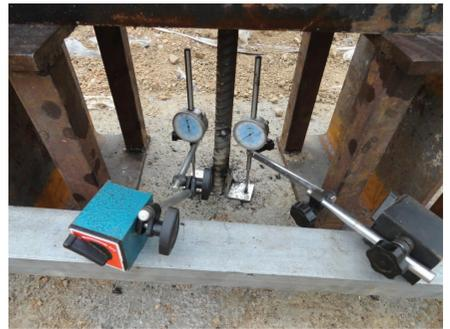
图 5 钢筋抗浮锚杆上拔量测试装置图
