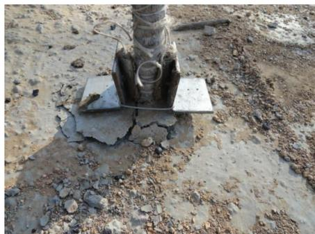
图 6 GFRP 抗浮锚杆滑移破坏
