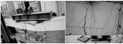
图2 叠合梁试件典型破坏形态及纯弯段裂缝图
