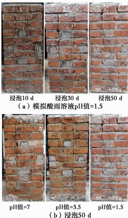
图 4 砖柱轴压破坏图
