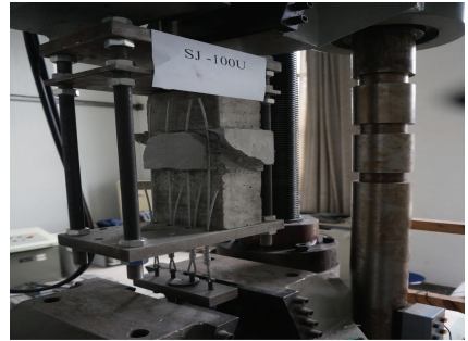
图 5 试件 SJU 粘结面剪切破坏
