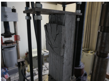
图 4 试件 SJD 粘结面剪切破坏图
