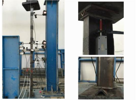
(a) 加载装置 (b) 试件顶端和底端局部
