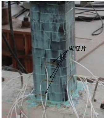
图 3 HDPF 条带测点应变片布置
