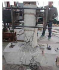
图 4 Z I-1 试件 破坏形态
