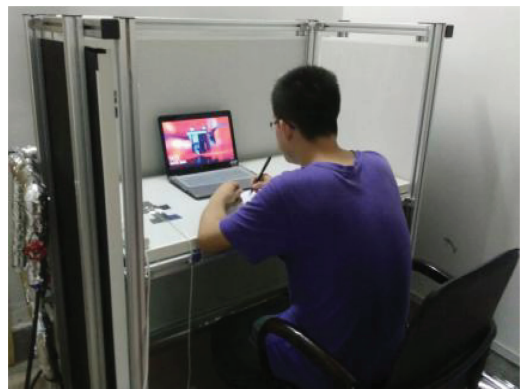
图 2 工位辐射空调实物图
