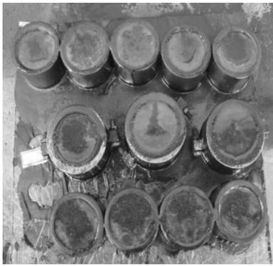
图 1 室外试样塌陷泌水
