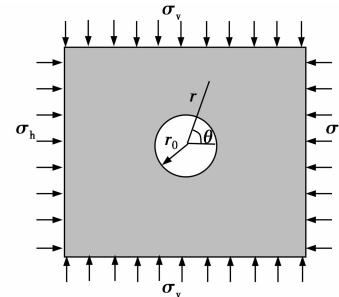
图 1 圆形洞室计算模型
