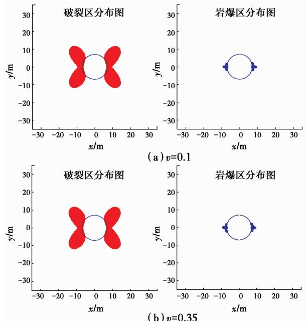
图 16 不同泊松比条件下围岩破裂区及岩爆区分布
