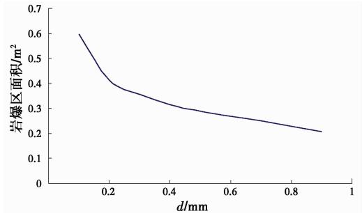
图 6 不同岩石颗粒直径下围岩岩爆区面积变化规律
