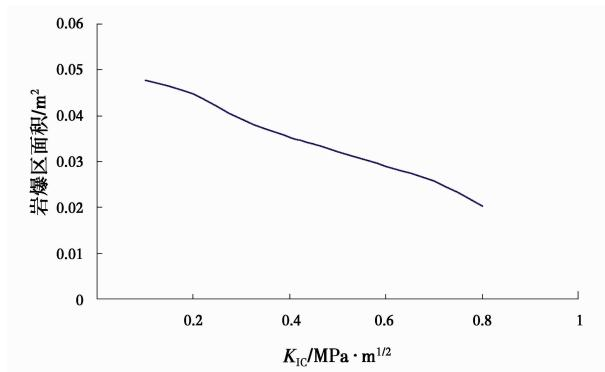
图 14 不同岩石断裂韧度条件下围岩岩爆区面积变化规律
