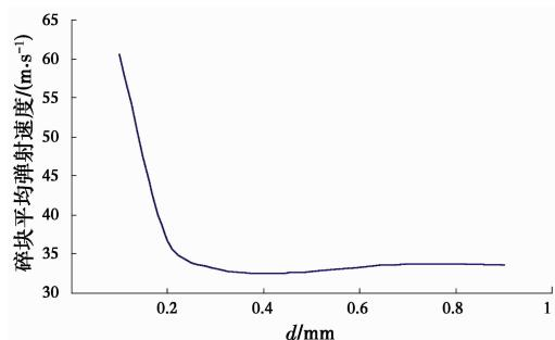
图 7 不同岩石颗粒直径下碎块平均弹射速度
