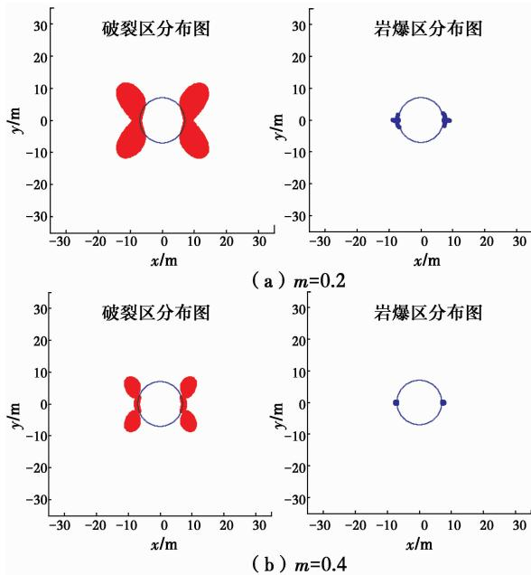
图 8 岩体峰值荷载前和后的模量比率系数对围岩破裂区及岩爆的影响
