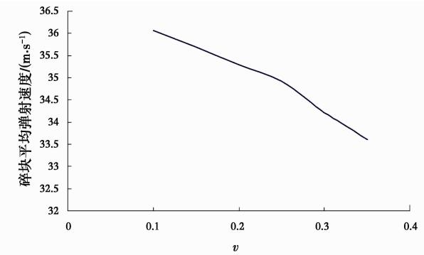
图 18 不同泊松比条件下碎块平均弹射速度
