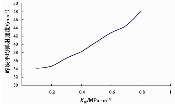
图 15 不同岩石断裂韧度条件下碎块平均弹射速度
