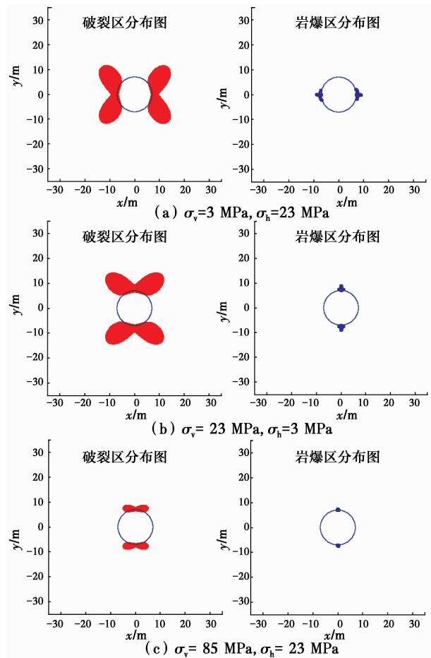
图 2 不同应力状态下围岩破裂区及岩爆区分布
