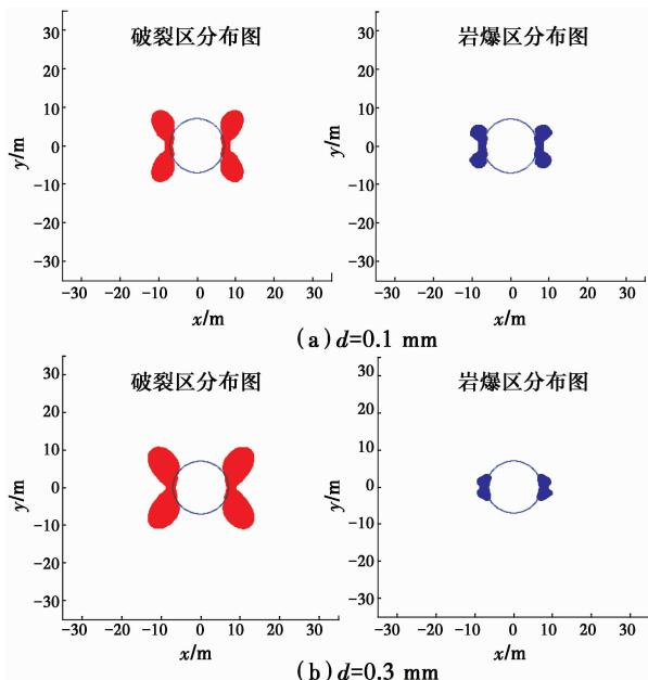
图 5 不同岩石颗粒直径条件下围岩破裂区及岩爆区分布
