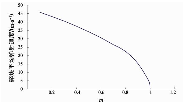
图 9 岩体峰值荷载前和后的模量比率系数对碎块平均弹射速度的影响
