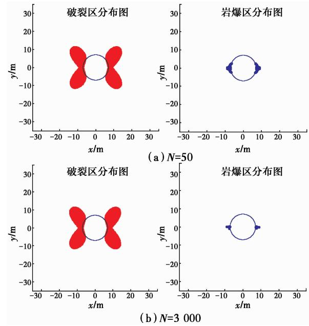
图 10 不同裂纹密度条件下围岩破裂区及岩爆区分布规律
