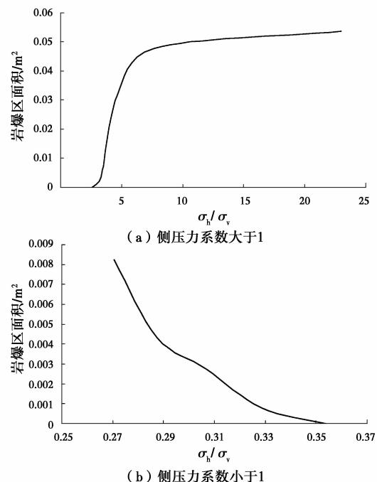
图 3 不同应力状态下围岩岩爆区面积变化规律
