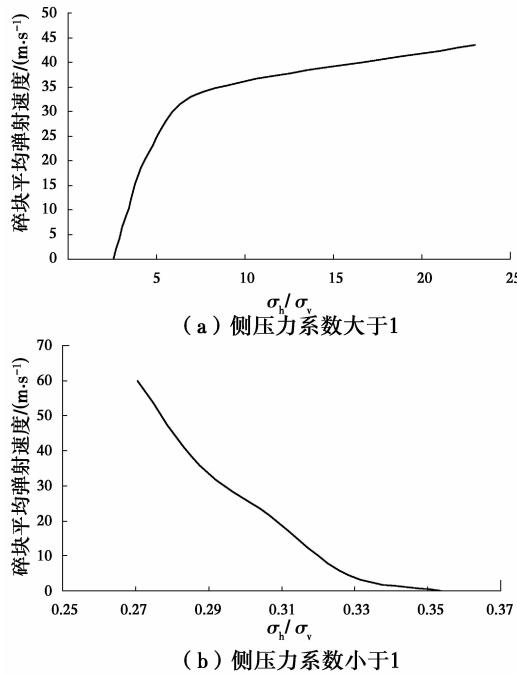
图 4 不同应力状态下碎块平均弹射速度
