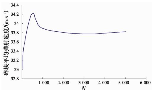
图 12 不同裂纹密度条件下碎块平均弹射速度
