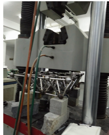
图 2 网架加载试验
