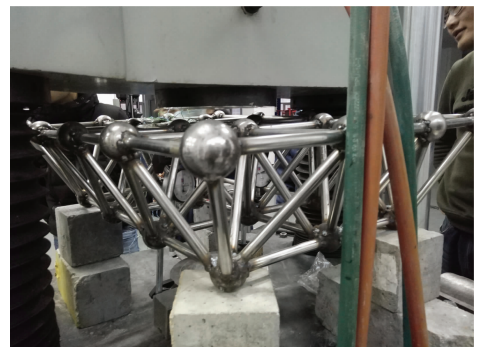
图 3 上弦杆件损伤程度识别试验
