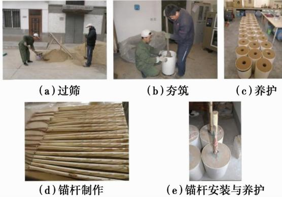
图 1 室内试验模型制作过程
