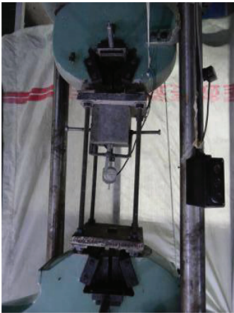
图 2 直接拔出试验加载装置
