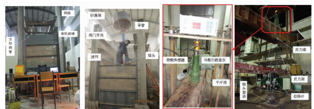
(a) 模型槽装置 (b) 砂雨法施工 (c) 抗拔加载装置
