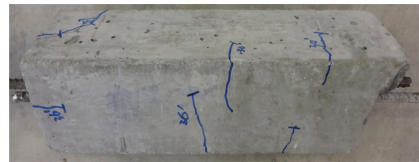
图 8 试件 C2-L2-B 最终破坏形态
