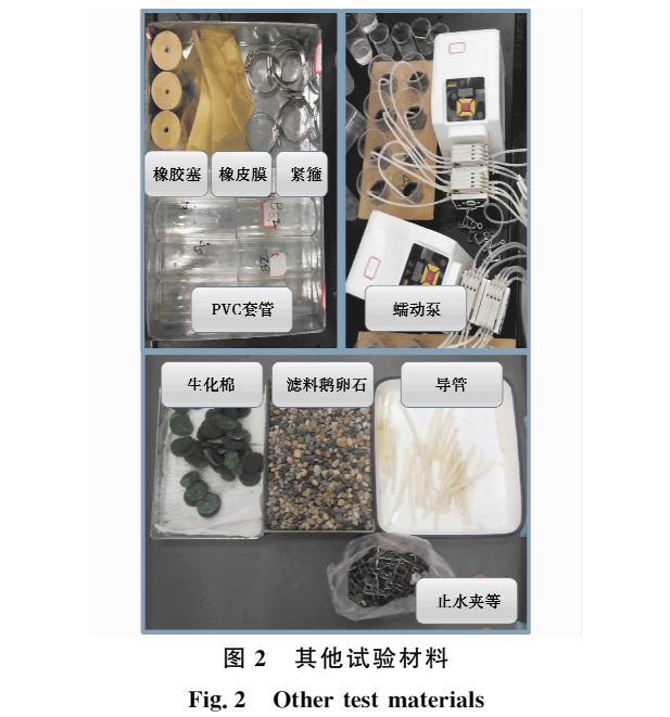
1)透明 PVC 套管内径为 40 mm,在筒壁上开一
