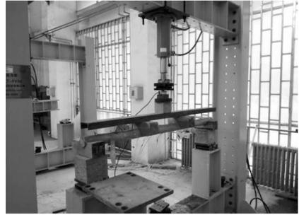
图 4 弹性模量的测量
