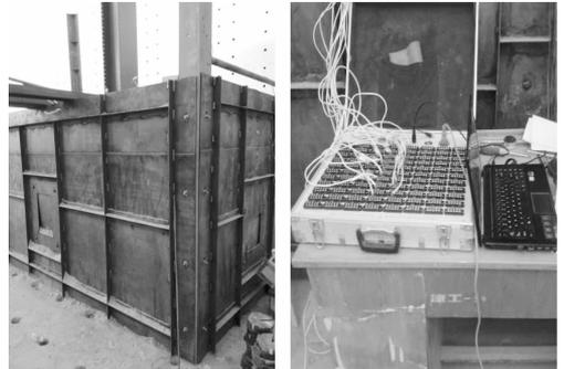
图 1 试验槽和数据采集装置
