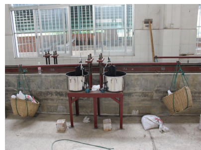
图 2 土样浸泡加载联动试验
