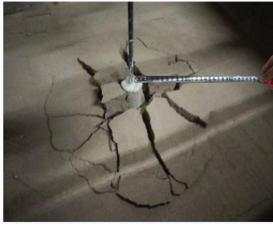
图 7 浅埋球索基础地表破坏情况
