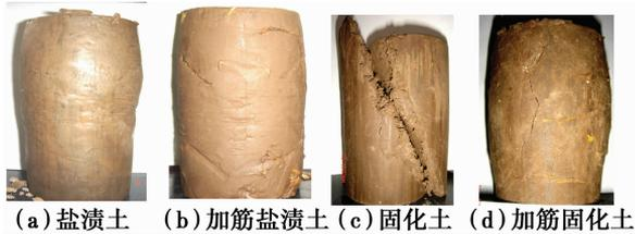
图 11 4 种试样的剪切破坏形态
