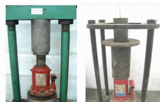
(a) 制样装置 (b) 脱模装置
