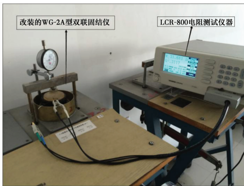
图4 固结仪上土电阻率测试示意图
