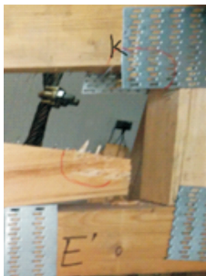
图 9 木桁架 PT-D 破坏现象
