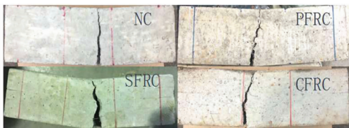
图 4 弯曲破坏形态
