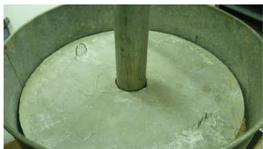
图 15 刚性混凝土承载板
