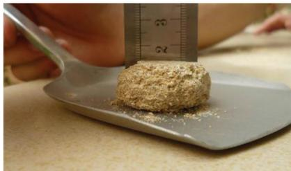
图10 压碎变形的褥垫层
