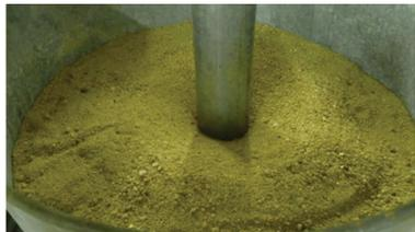
图9 76 mm模型桩刺入中期时褥垫层表面的局部隆起
