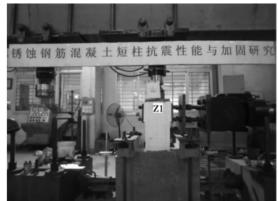
图 4 拟静力试验加载装置
