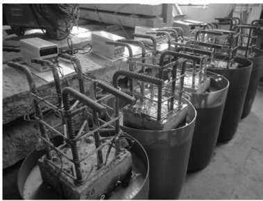
图 2 电化学锈蚀试验装置
