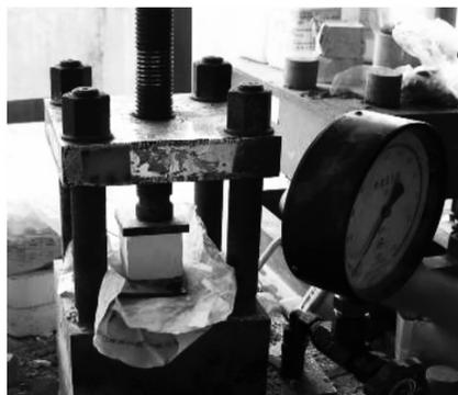
图1 自制抗压强度测试仪
